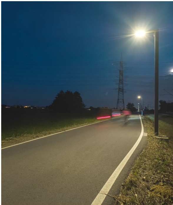
Radweg außerhalb eines bebauten Gebietes mit adaptiver, naturschonender Beleuchtung: Die volle Leuchtkraft wird nur erreicht, wenn sich Zu Fußgehende oder Radfahrende nähern (linkes Bild). Ohne Verkehr werden die Leuchtkörper gedimmt (rechtes Bild).
