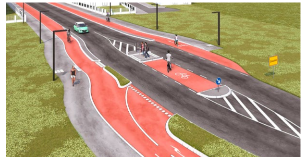
Sichere und zügige Überleitung in den innerörtlichen Einrichtungsverkehr mit einer Verkehrsinsel
