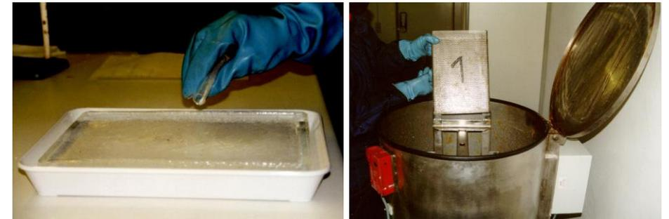
Inzeller Eisplattenverfahren zur Wirksamkeitsuntersuchung der Tausalzleistung der Streustofflösungen
