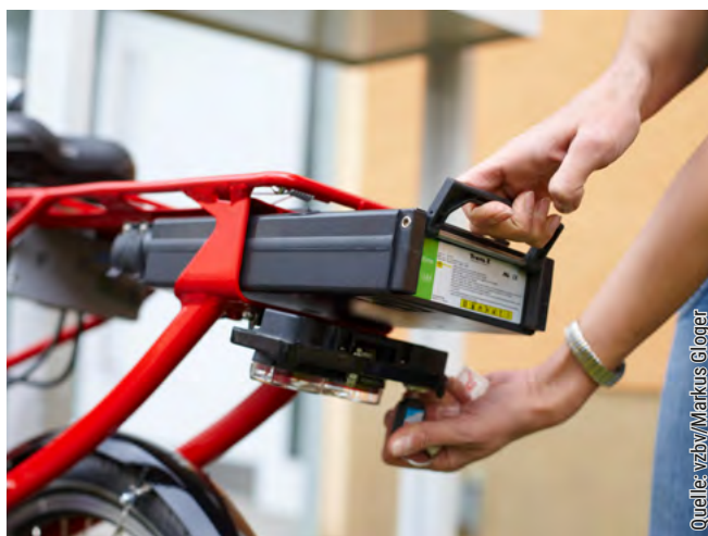
Abb. 06: Akku wird zum Aufladen vom Pedelec getrennt
