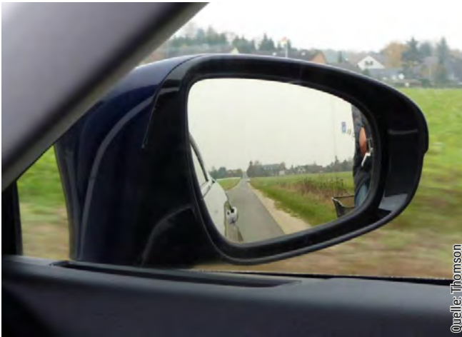
Abb. 41: Außenspiegel mit asphärischem Bereich und Totwinkel-Assistent
