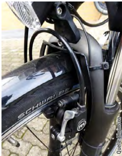
Abb. 03: V-Brake (hier mit Bremsmodulator)
